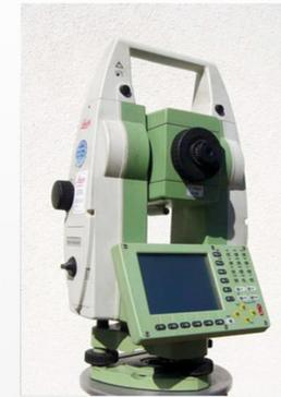
In meinem Büro verwenden wir Instrumente der Firma LEICA®. Als elektrooptische Tachymeter mit reflektorloser Streckenmeseinheit kommen die Gerätetypen TS15 A2, TS15 P5 und TS16 P2 zum Einsatz. Bei GPS-Messungen verwenden wir den Gerätetypen GS07 und GS18 T unter Verwendung
